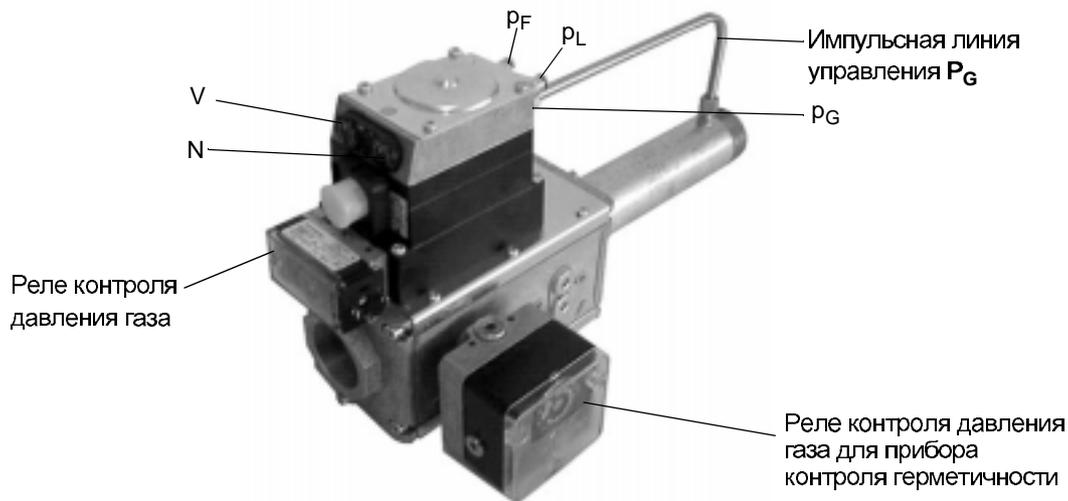
Соединительная трубка синего цвета служит как воздушная линия управления для компактного газового блока и должна пролегать в свободном изгибе. Разрежьте синюю трубку на две части. Одной половиной синей трубки соединить ниппель **Р<sub>L</sub>** на компактном газовом блоке с штуцером на газовой обойме, второй половиной трубки соединить ниппель **Р<sub>F</sub>** с штуцером топки котла. Трубку проложить так, чтобы конденсат не мог проникнуть в компактный блок, а стекал обратно в топочную камеру.
