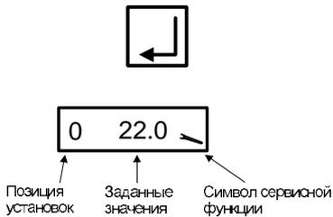
Для того чтобы открыть сервисную функцию необходимо удерживать нажатой примерно 2 сек. кнопку «Подтвердить». На дисплее высветится точка **P0** и заданные значения воздушной заслонки сервопривода при розжиге в градусах и символ «отвёртки», обозначающий сервисную функцию.
