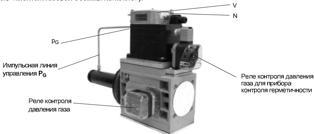
Соединительная трубка синего цвета служит как воздушная линия управления для компактного газового блока и должна пролегать в свободном изгибе. Разрежьте синюю трубку на две части. Одной половиной синей трубки соединить ниппель **P<sub>L</sub>** на компактном газовом блоке с штуцером на газовой обойме, второй половиной трубки соединить ниппель **P<sub>F</sub>** с штуцером топки котла. Трубку проложить так, чтобы конденсат не мог проникнуть в компактный блок, а стекал обратно в топочную камеру.
