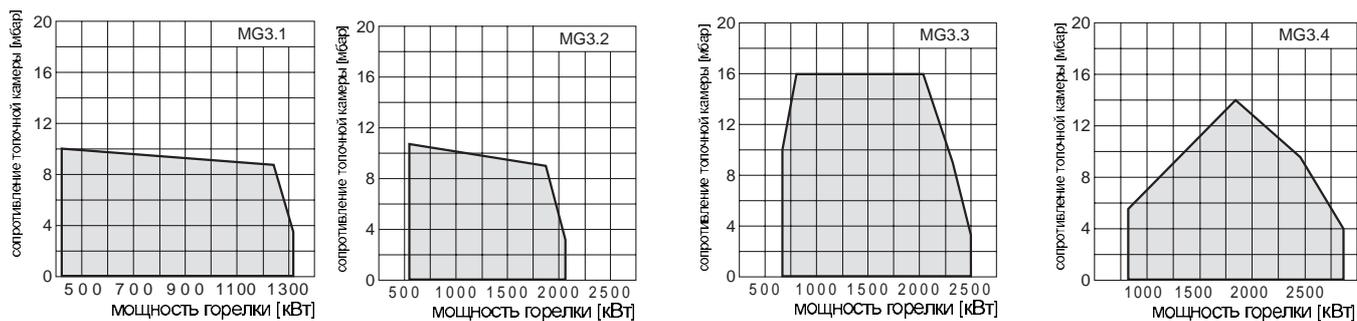
Проверенные TÜV рабочие зоны согласно DIN EN 676. Рабочие зоны действительны для высоты прим. 200 м над уровнем моря и окружающей температуры 20°C.
